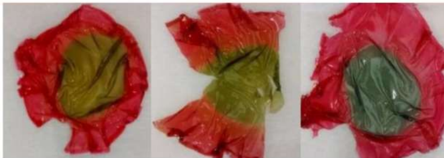
A embalagem muda da cor vermelho para verde, indicando a deterioração do alimento - Foto: Pedro Luiz Manique Barreto
