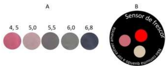
Figura 2. Indicadores de frescor, que variam a cor de acordo com a acidificação de leite (A) e com a variação do pH de frutos do mar (B).
